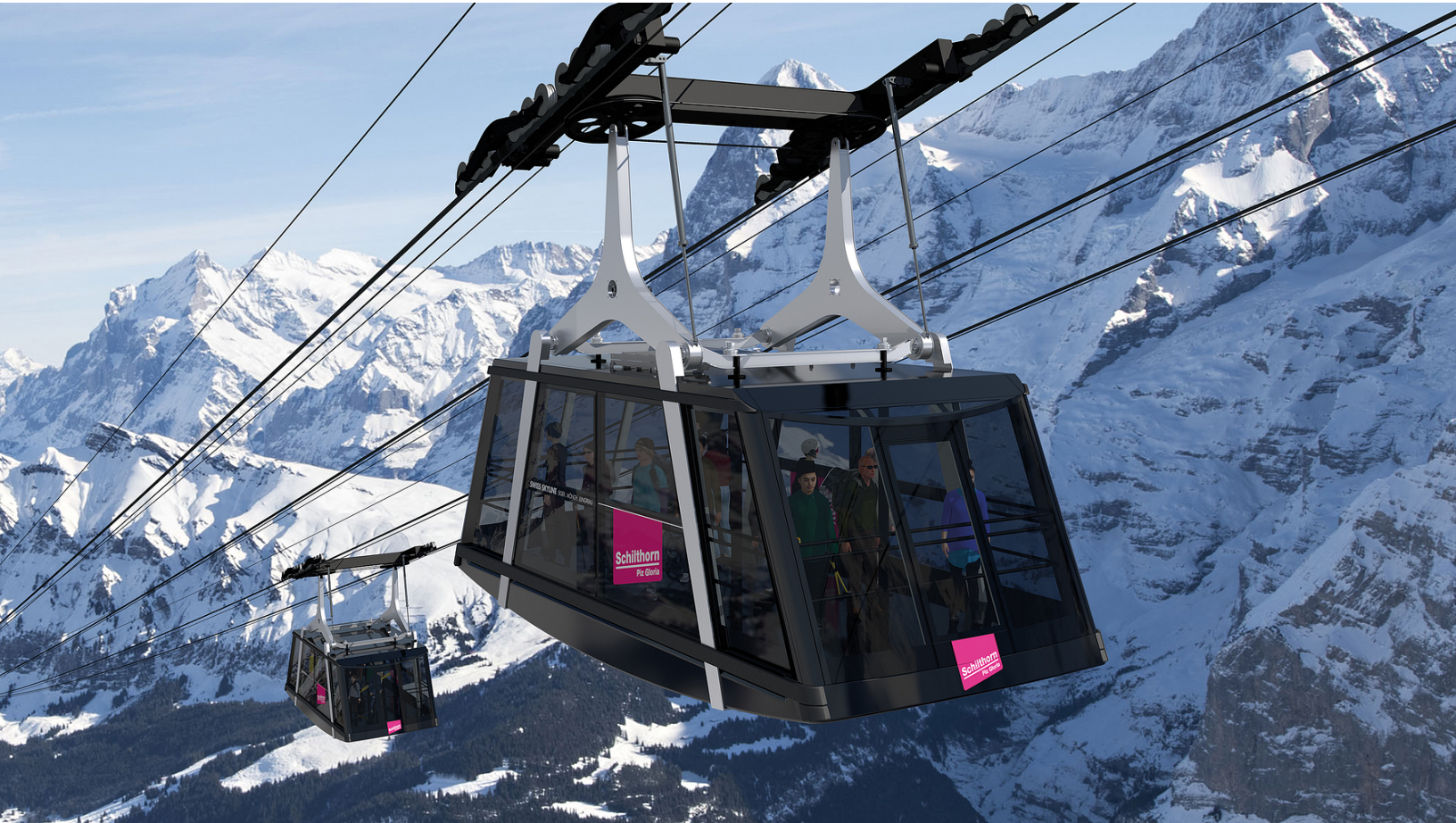
Visualisation du cabine de téléphérique en système Funifor
